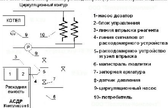
Рис.1.6. Принцип работы ВПУ
