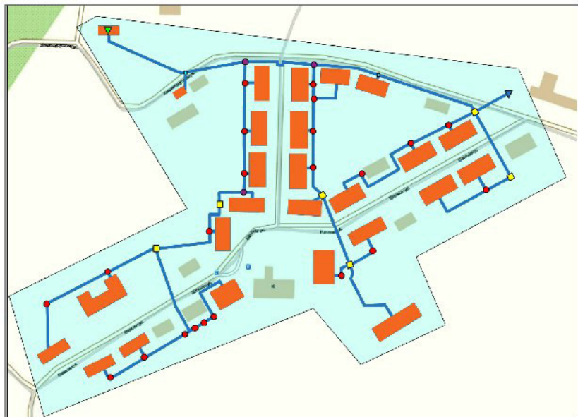
Рисунок 1.5 – Зона действия централизованного теплоснабжения котельной В олошово-2
