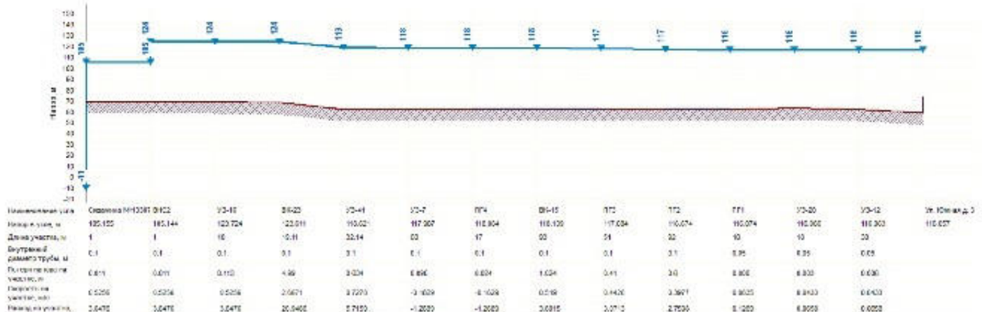
Рисунок ВС-5. Пьезометрический график от скважинного водозабора № 10307 до потребителя «ул. Южная д. 3»
