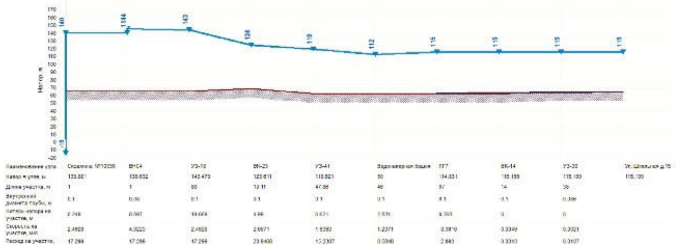
Рисунок ВС-9. Пьезометрический график от скважинного водозабора № 10336 до потребителя «ул. Школьная д. 15»
