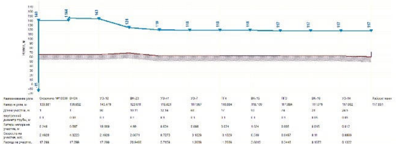
Рисунок ВС-8. Пьезометрический график от скважинного водозабора № 10336 до потребителя «Лаборатория»
